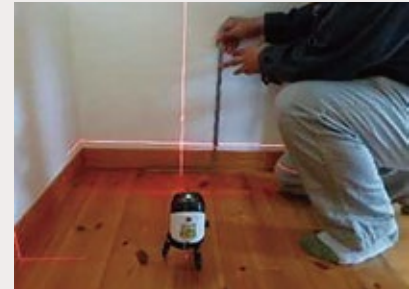
「床の傾きを計測する」調査機器
